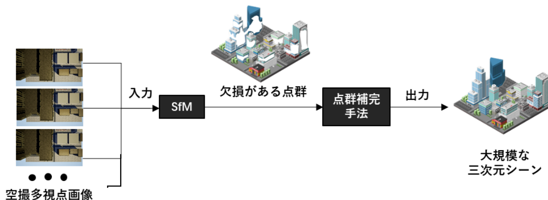
図 2 大規模なビジョンベースのシーンの復元と補完の全体的なプロセスを示す。まず、UAV で空中多視点画像を取得し、SfM で三次元シーンを復元する。次に、本論文で提案した壁面点群補完法により、広いシーンの点群地図を得ることができる。
