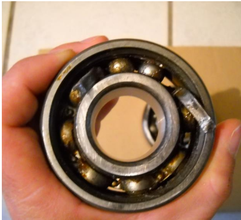
3.3. ábra Csapágykosár-törés, idegen fém bejutása miatt. A kopási határvonal, határterület kidolgozásának alapvető indítéka volt az ábrán látható kosár állapota.
